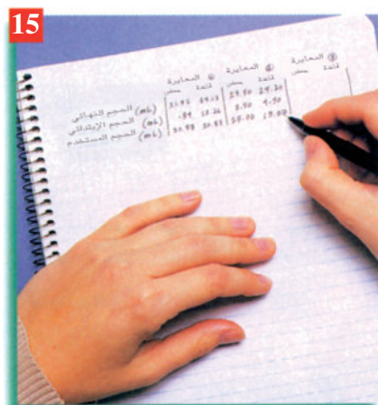
15 قهباری دهستی پیکي لسهر پیقهري ژ خواندنا دویماهی دهرکه. بهایی ههمی قهبارهی وی تفتي کریه ئامانی دیاردکته. ئه نجامی بنقیسه و ژ 0.01 mL نیزیک بکه.
