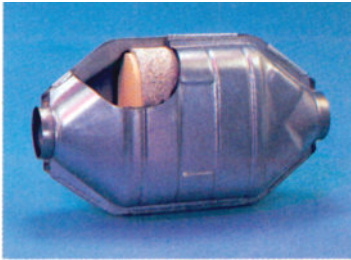
جوړه بگورپکی هاندەر، که له نۆتۆمبیلدا به کار دیت، پارچه یه کی لی بردراوه تا کو ئه ماده سیرامیکه کونیه داره دهریکه ویت که وهک بنچینه یه کی بگورپکه کار ده کات.
