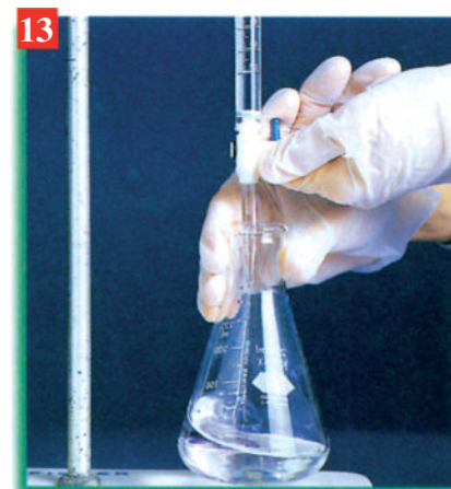
13 سهنگاندا دخالا دویماهیکی دا نیزیک دبیت دهمی رهنکی پیقازی گولی بو ماوهکی پتر قه مینیت. دق خالیدا دلوپ دلوپ تفتي بیخه سهر که موله ی (ئامانی).
