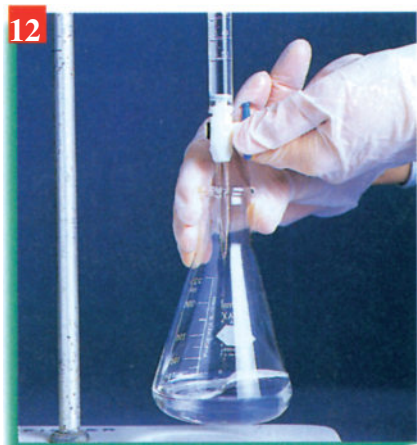
12 هیدی هیدی تفتي د پیقهري دا بکه سهر ترشی دئامانی قوچکدا و تو بشیوهکی بازنه ی ئامانی دلینی. پیدیه رهنکی پیقازی دهمی لقیندا لناف بچیت و نه مینیت.
